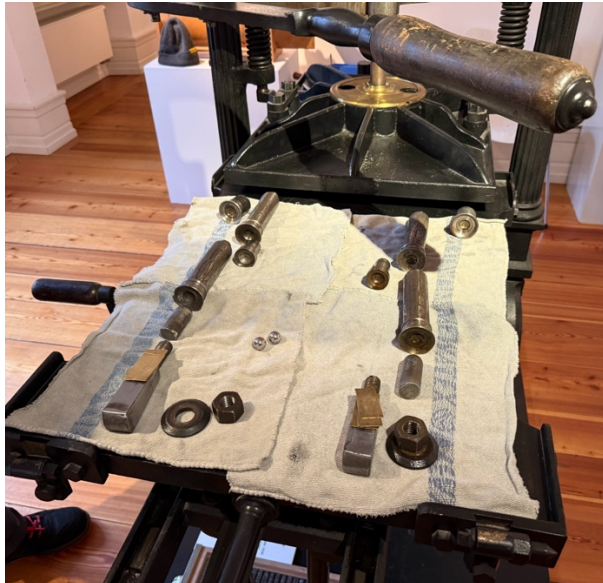
Abbildung 5 - Die zerlegten Mechanismen links, rechte Seite: Funktionslängen der Bauteile (Messung m. eingeleger Kugel)
