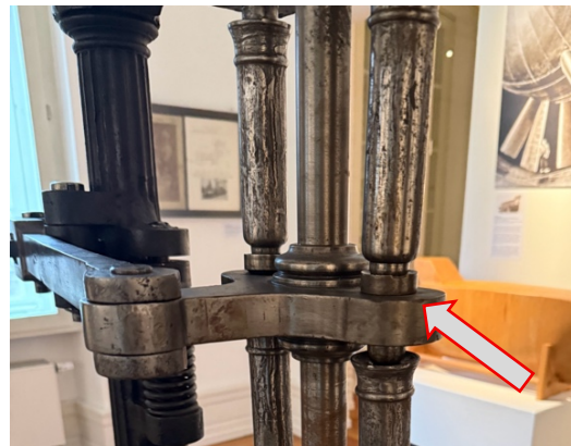
Abbildung 6 – Die blockierte Nachstellung (Pfeil), 1982 - linkes Bild und 2026 - rechtes Bild 2
